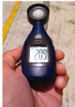
Misurazione con luxmetro con il nuovo impianto
